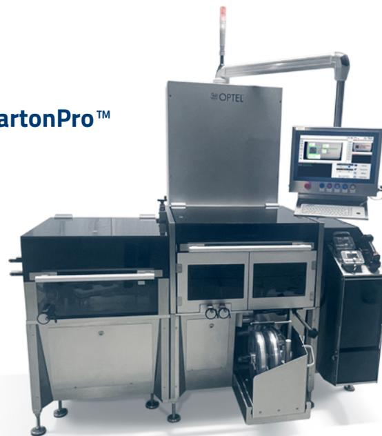
Modelo exibido com opções integradas de lacre de segurança (Tamper Evident) e verificador de peso (Checkweigher).
